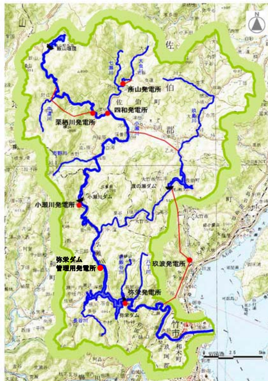
図-5.1.3 小瀬川水系発電所模式図
