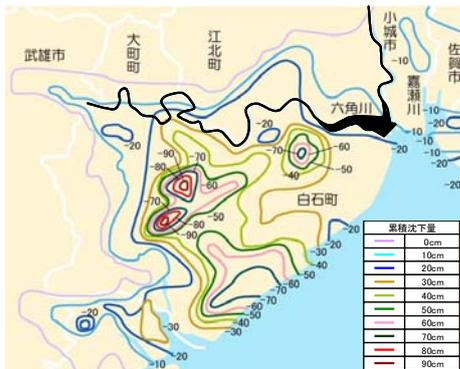
図5-4 地盤沈下累積等量線図 (S47.2~H7.2)
