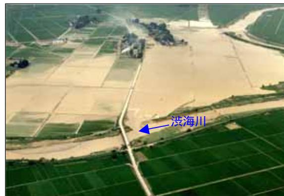
写真 4-24 渋海川破堤状況
