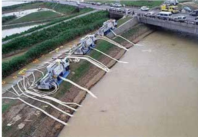
写真 11-6 排水ポンプ車による排水の状況
