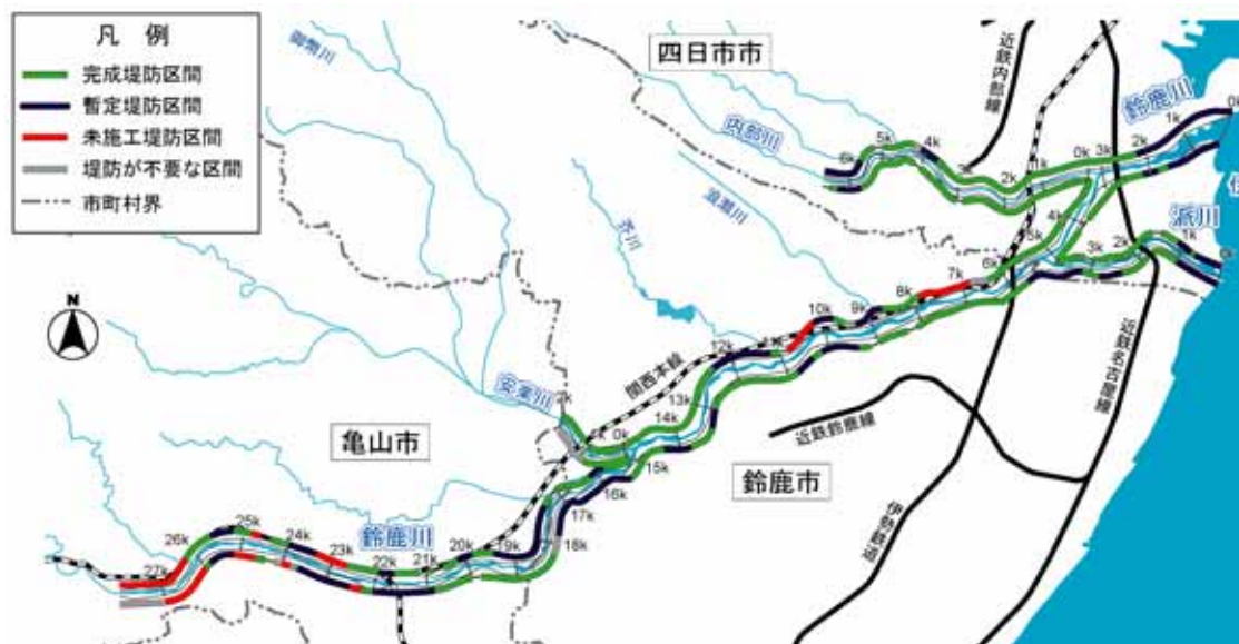
図 9 - 2 堤防整備状況
