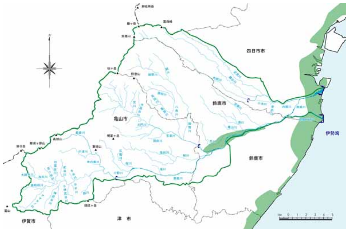
図 4－1 浸水区域図（昭和 34 年 9 月洪水）
