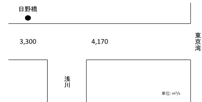
図 4-2 昭和7年 多摩川上流改修工事 計画高水流量配分図
