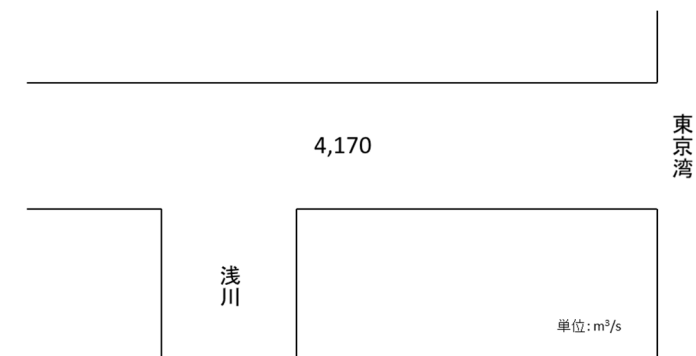
図 4-1 大正7年 多摩川改修工事 計画高水流量配分図
