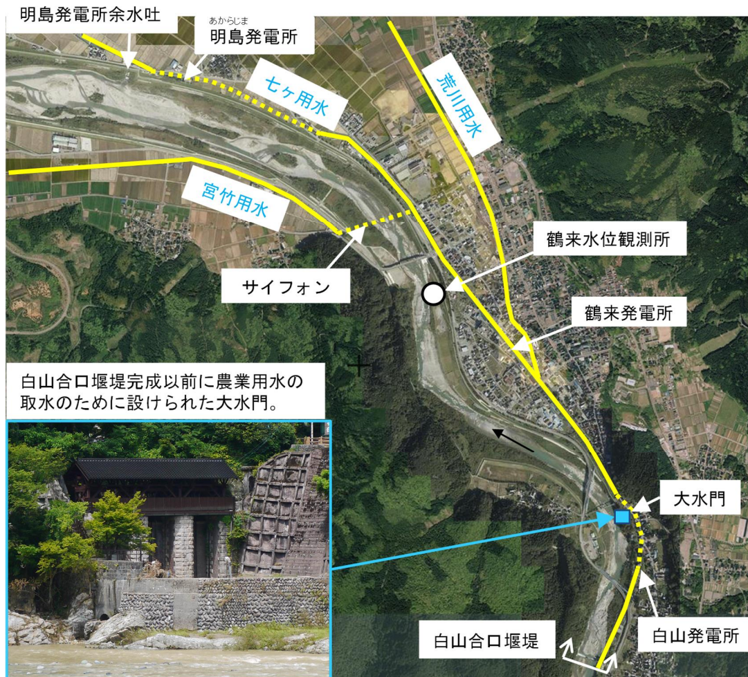
図 5-3 白山合口堰堤下流の水利用状況
