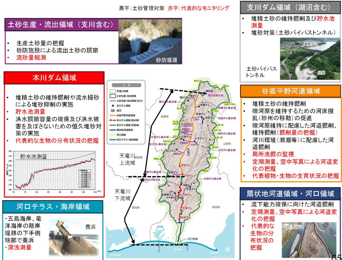
図 1-2：各領域での土砂管理対策及びモニタリング
