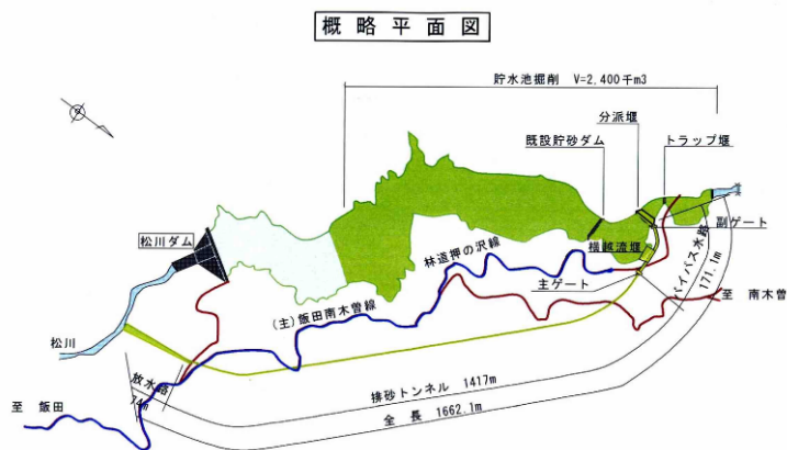
4-22 : 松川ダム洪水バイパスの概要
