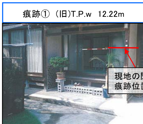
昭和10年8月洪水における痕跡水位 図4-8 昭和10年8月洪水におけるピーク流量の推定
