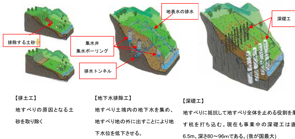
図 4.21 主な地すべり対策工
