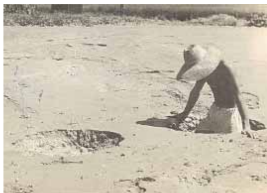
ボイリング現象によってできた大噴口、畑地は流砂に覆われてしまっている。(石井町)
