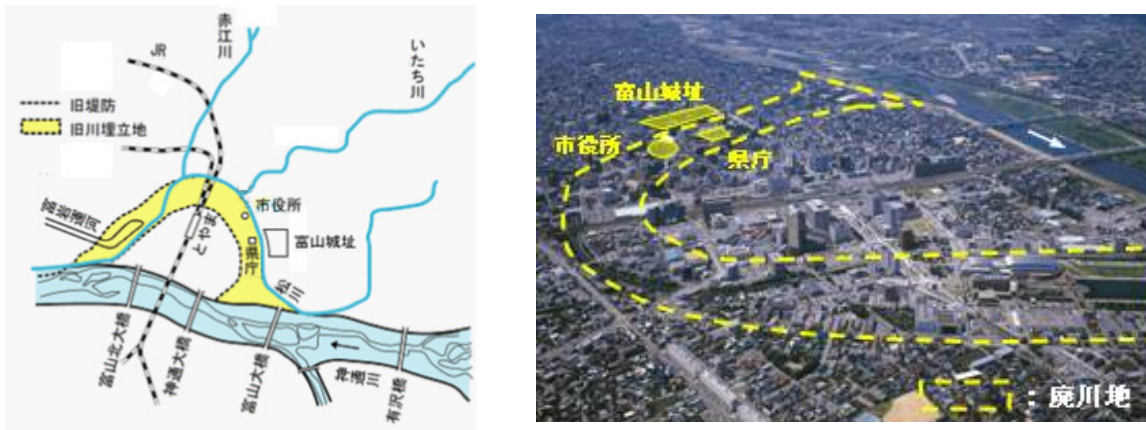
図 4-2 馳越線新設工事
