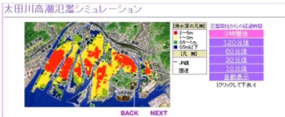
図 2-3 高潮氾濫シミュレーション事例 (国土交通省太田川工事事務所より公表)
