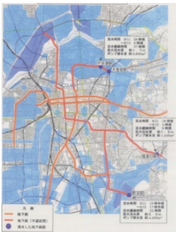
図 1-4 東海豪雨時の地下鉄の不通区間と浸水した駅（国土交通省作成）
