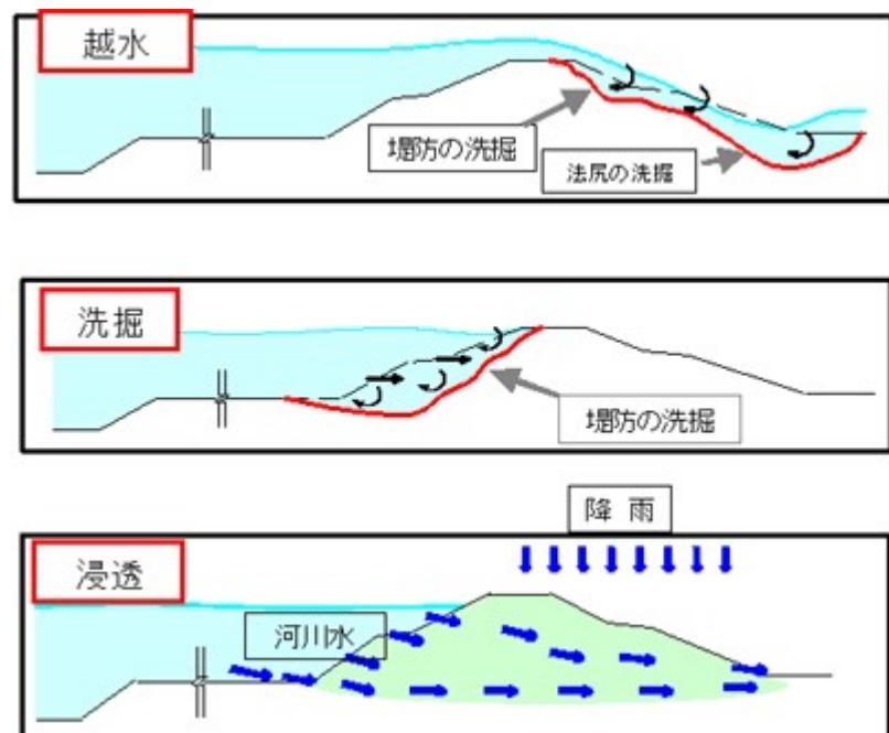
図 3-17 堤防の決壊メカニズム
