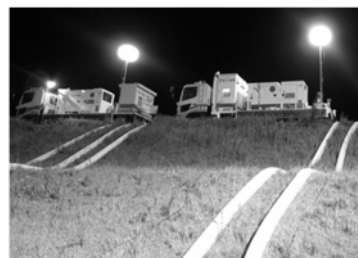
浸水エリアに排水ポンプ車を派遣し緊急排水を実施 (H25.9 台風 18 号 京都府福知山市)
