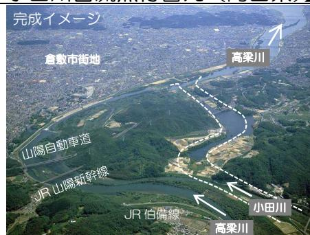
高梁川本川と支川の小田川の合流点を下流に付け替えることにより、洪水時の水位を低下させ、倉敷市など沿川流域の治水安全度の向上を図る。
