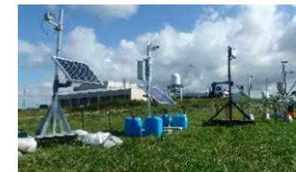
簡易型河川監視カメラ (現場実証状況)
