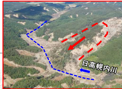
河道閉塞状況
