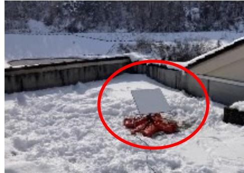
▲低軌道周回衛星を使用した衛星通信装置
