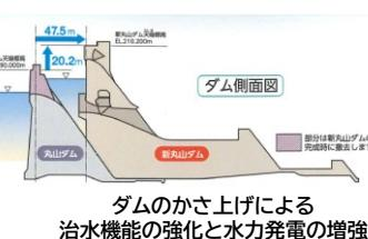
ダムのかさ上げによる治水機能の強化と水力発電の増強
