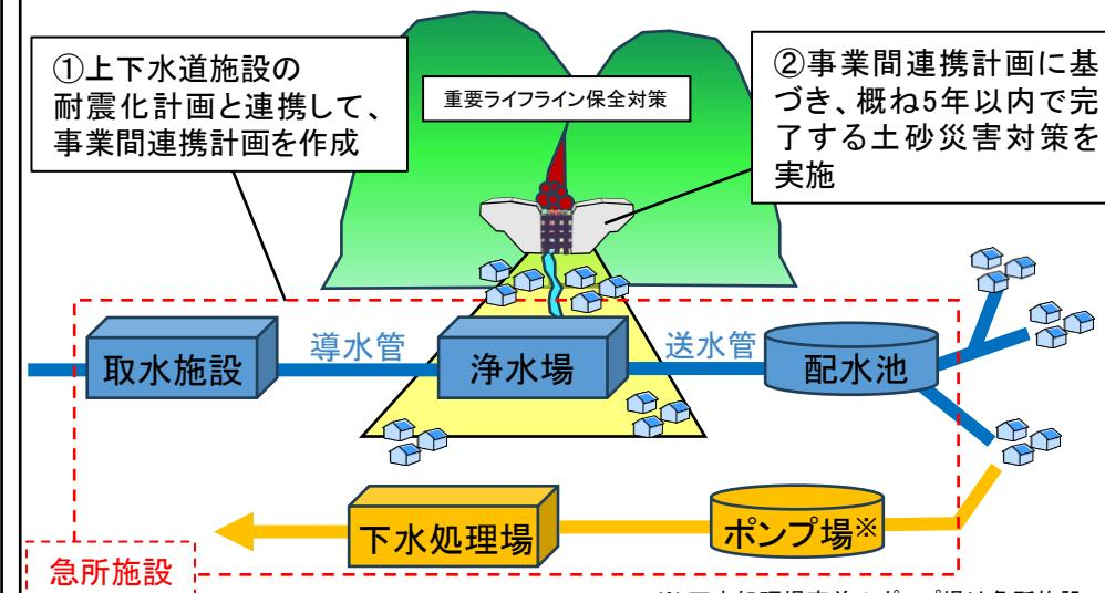
上下水道のシステムの急所となる施設を保全する土砂災害対策のイメージ
