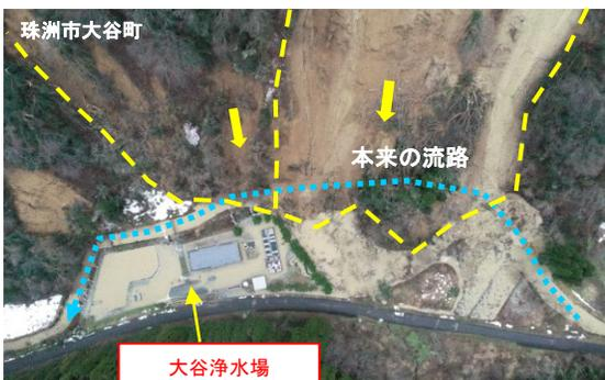
浄水場を機能停止にした河道閉塞
