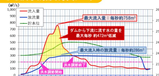
月山ダムで約524万m<sup>3</sup>(東京ドーム約4.2杯分)を貯留し、約1.1m水位を低減
