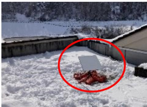
▲ 低軌道周回衛星を使用した衛星通信装置
