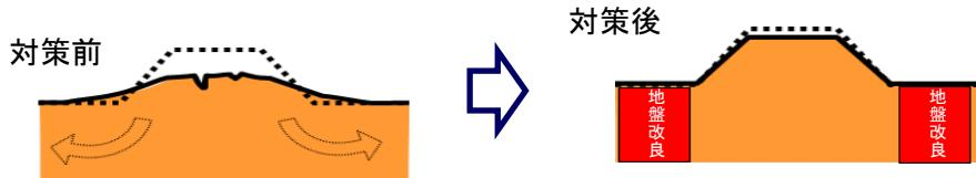
地盤改良により、堤防の変位が少くなり、強固な堤防となる。
