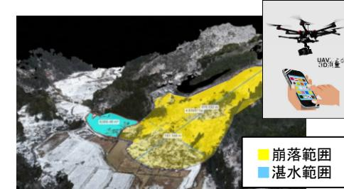
▲ドローン空撮画像から作成した3次元モデル
