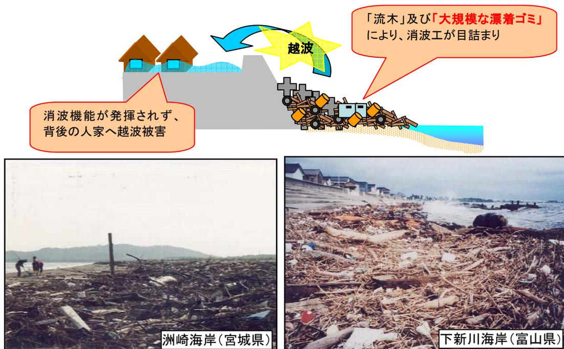
大規模な漂着ゴミを含む流木等の堆積により消波機能が低下した海岸
