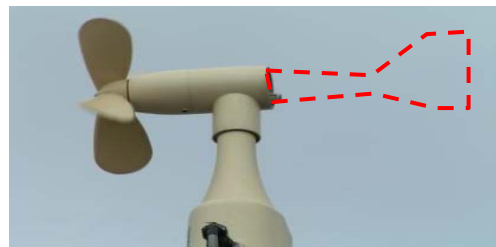
台風により風向・風速計の尾翼が損傷し、1年以上にわたり欠測
