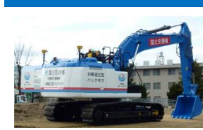
分解組立型（遠隔操作式）バックホウ
