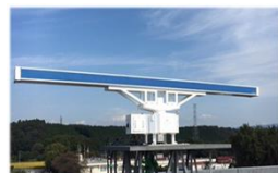
（新型）レーダー空中線回転機構部
