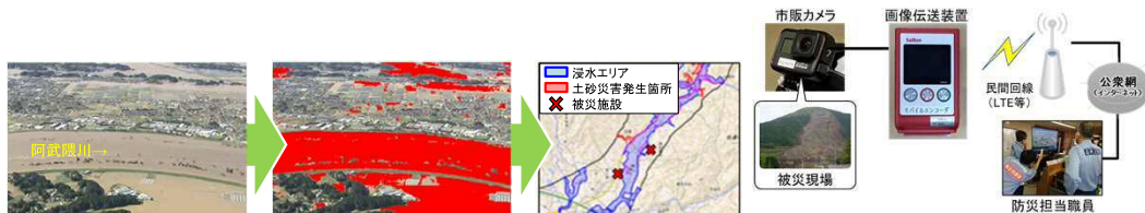
ヘリ映像を用いたAIによる浸水範囲等の自動抽出 公衆網（民間回線）を使用した画像伝送システム
