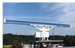
(新型) レーダー-空中線回転機構部
