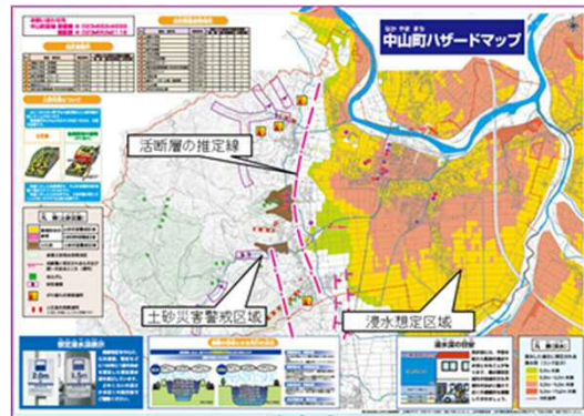
ハザードマップに活断層を重ね合わせた事例 出典：山形県中山町ハザードマップ
