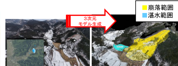
ドローン空撮画像を用いた3次元モデルの 作成と災害調査への活用
