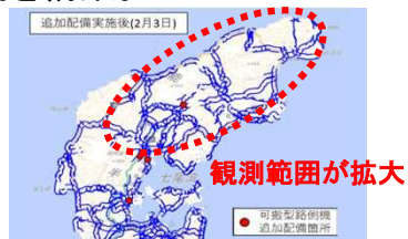
可搬型路側機追加配備による データ観測範囲の拡大
