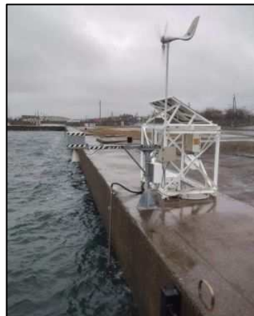
機動型津波観測施設の設置例
