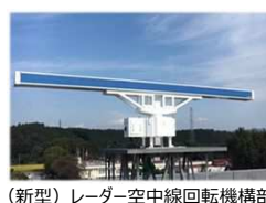
（新型）レーダー空中線回転機構部
