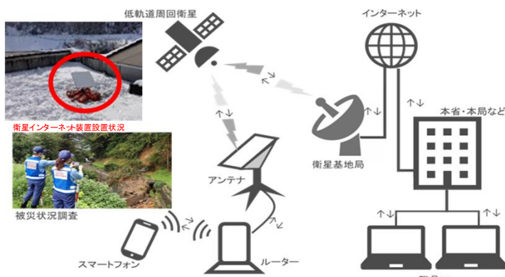
衛星通信設備等の増強
