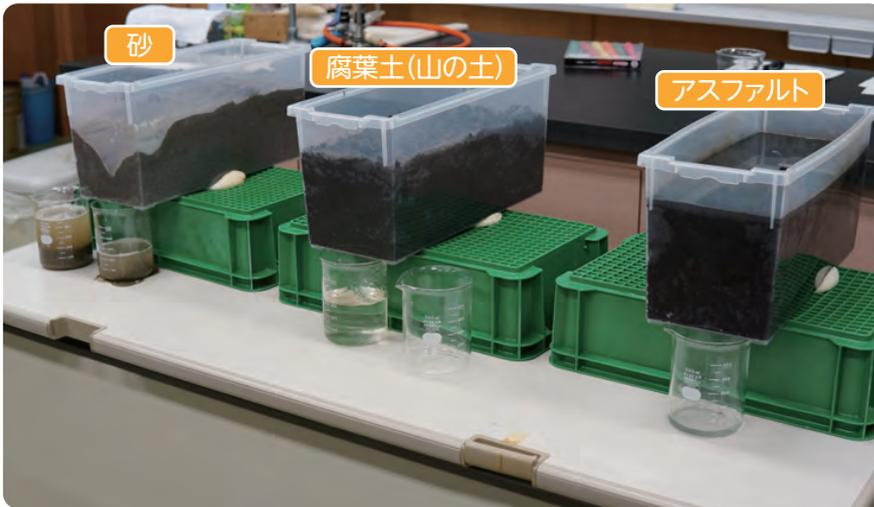
演示実験。地表(土壌)が異なると、浸透にどんな違いが出るのかを知る。「砂」「腐葉土(山の土)」「アスファルト」の3つのサンプルを用意。生徒に水を流させ、観察を促す。なお、実験前に、令和元年台風19号で甚大な被害を受けた丸森町の写真(内水氾濫)を見せることで、生徒たちの考えが深まるように留意した。
