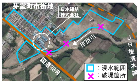
破堤による背後地への浸水状況
