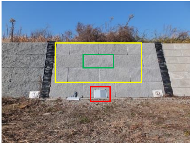
写真 2.32 明度測定時の写真撮影例と補正板
