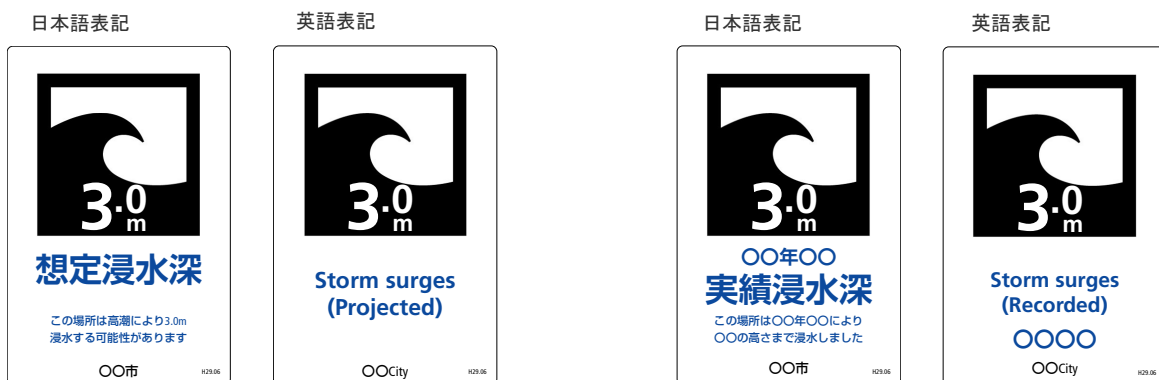
図-24 高潮標識(表示内容説明板)板面表示例
