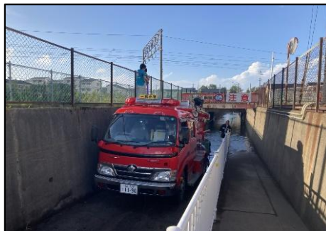
ハツ矢アンダー（ハツ矢町地先） 排水ポンプ車による排水作業
