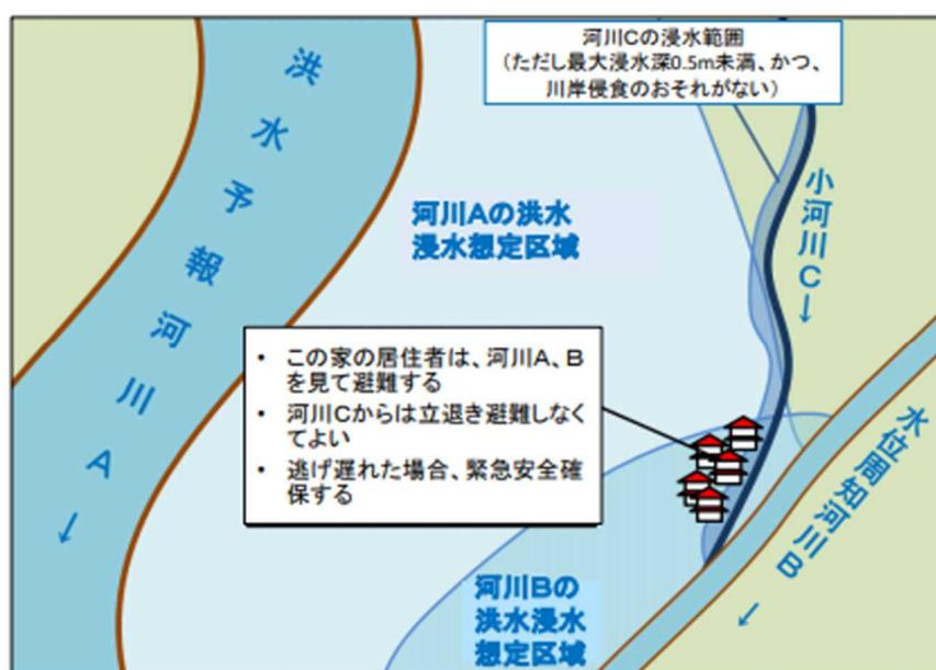
図-3.14 洪水の浸水範囲が重複する事例イメージ
