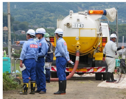
流出した油を回収するため 側溝清掃車を現地に派遣 (佐賀県大町町)
