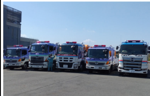
前進配備する排水ポンプ車
