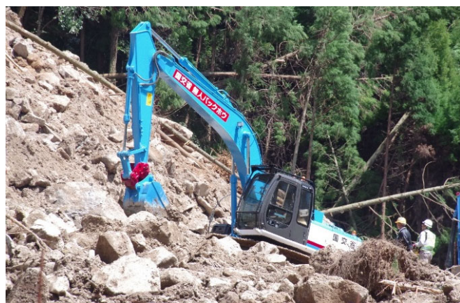
遠隔操作式バックホウによる捜索活動支援
