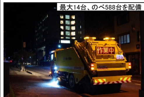
路面清掃車で粉塵除去(熊本県人吉市)
