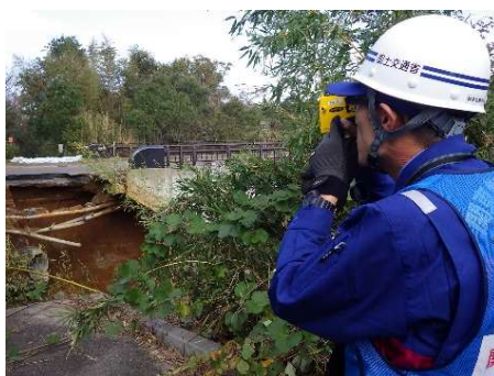
護岸と歩道の流出状況を レーザー距離計を用いて調査
