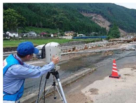
斜面崩壊現場の 24時間監視
