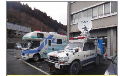
衛星通信車による途絶した通信回線の確保
