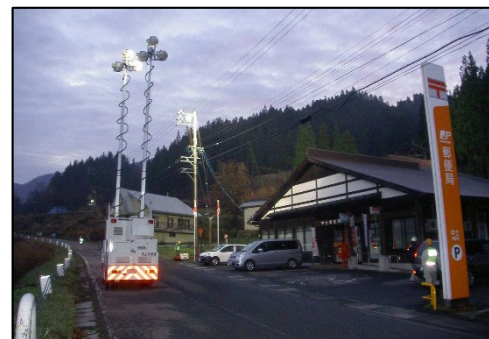
照明車による被災箇所の監視支援
