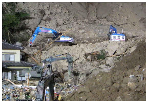
遠隔操作式バックホウによる搜索活動支援
