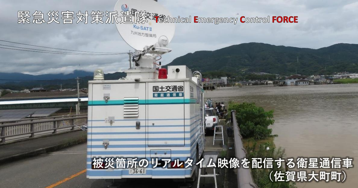
被災箇所のリアルタイム映像を配信する衛星通信車
