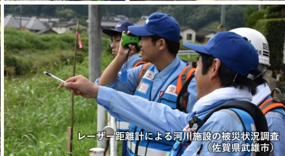
レーザー距離計による河川施設の被災状況調査
