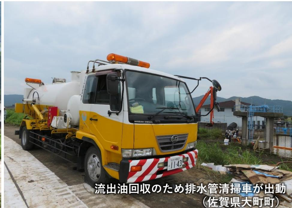
流出油回収のため排水管清掃車が出動
