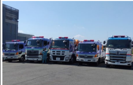
前進配備する排水ポンプ車
