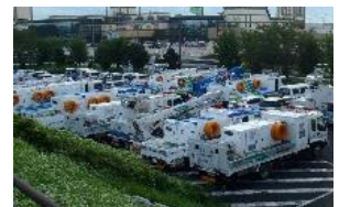
排水ポンプ車
