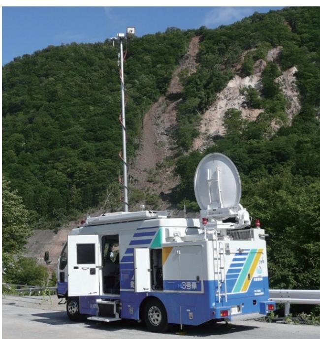
●衛星通信車を活用した河川せき止め箇所の常時監視
