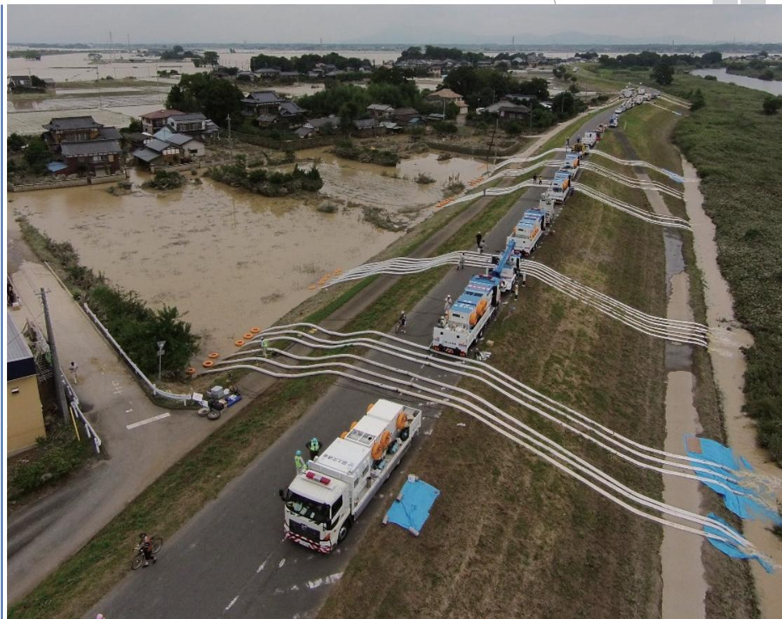
○排水ポンプ車の集中投入による緊急排水
