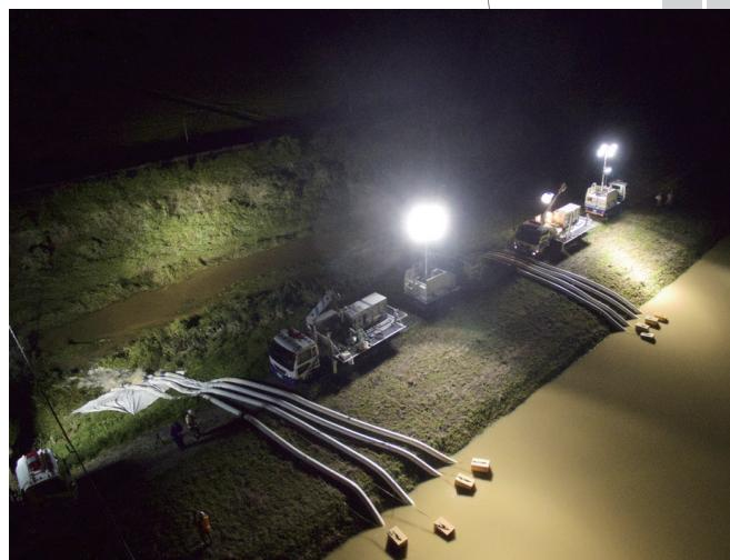
●排水ポンプ車による24時間体制の緊急排水（大崎市）
