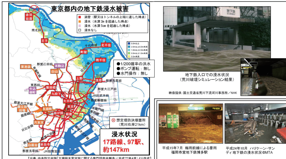
【図 1-1-11 荒川右岸の堤防が決壊し氾濫すれば地下施設に甚大な被害が発生】
