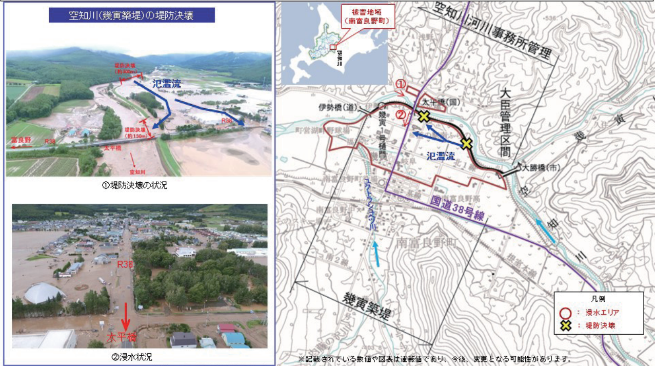
【図 2-12-8 上流の堤防決壊に伴う氾濫水により下流堤防が決壊 (石狩川水系空知川)】
