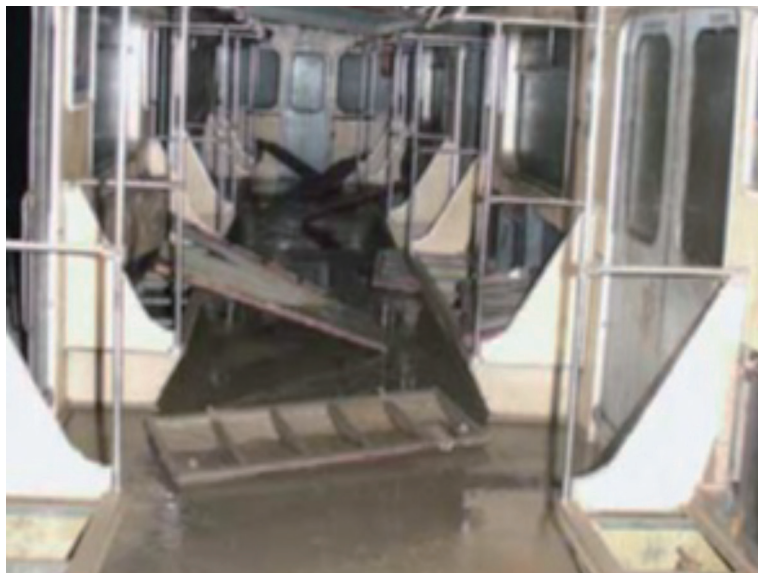
【図 2-17-4 洪水により水没した地下鉄車両】
