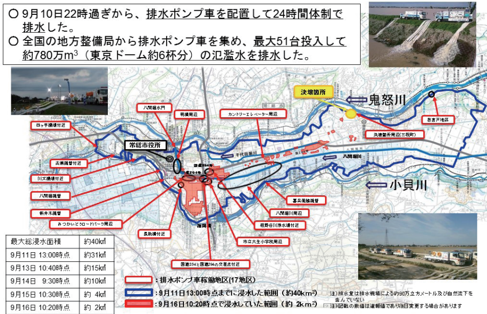
【図 2-11-10 排水ポンプ車による氾濫水の排水】
