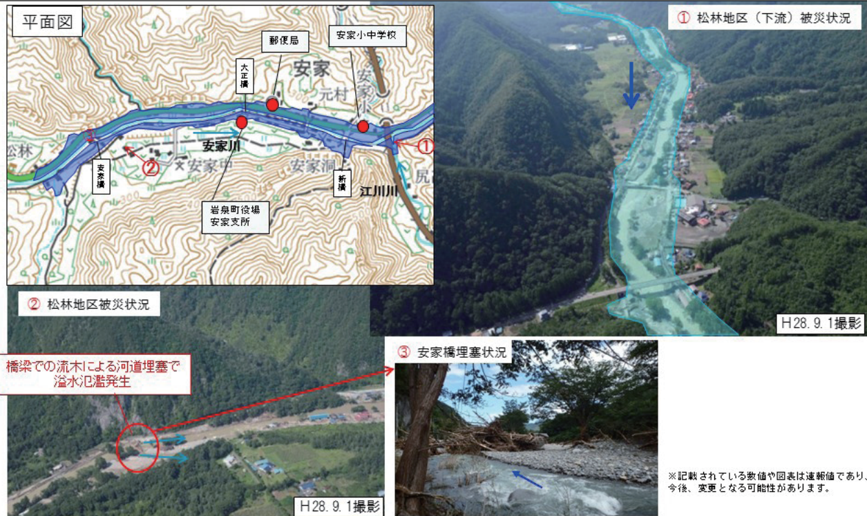
【図 2-12-12 流木を含む洪水により橋梁での河道埋塞や家屋流出被害が発生(岩手県安家川)】
