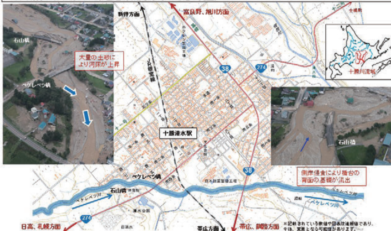
【図 2-12-9 河岸侵食などにより家屋流出や橋梁被害が発生 (十勝川水系ペケレベツ川)】
