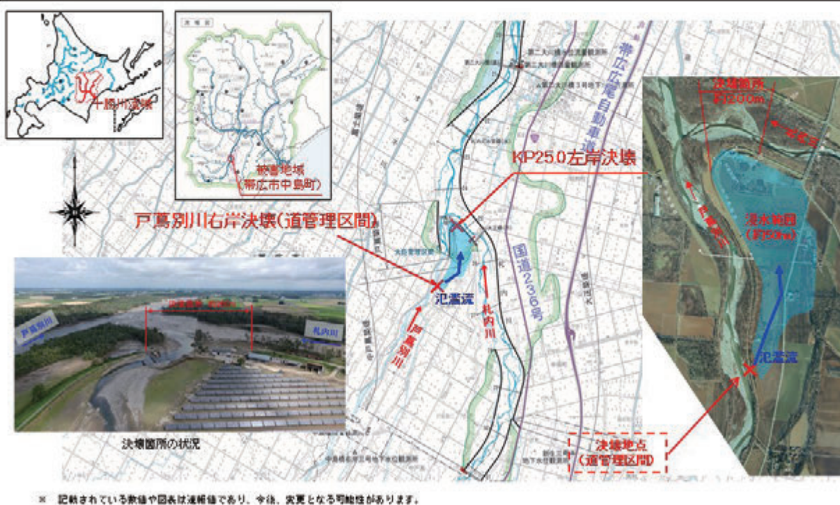
【図 2-12-7 支川の堤防決壊に伴う氾濫水により本川堤防が決壊(十勝川水系札内川)】
