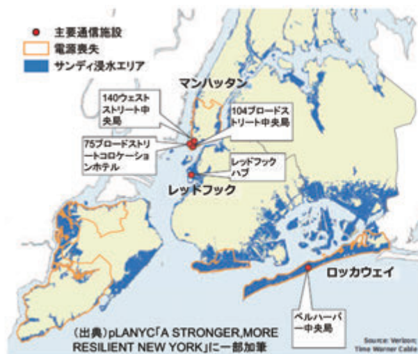
【図 2-20-4 サンディ襲来中の主要通信設備の停止状況】
