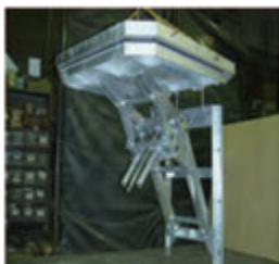
【③換気口の浸水防止機】
