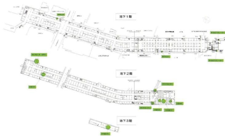
【浸水センサー設置箇所】
