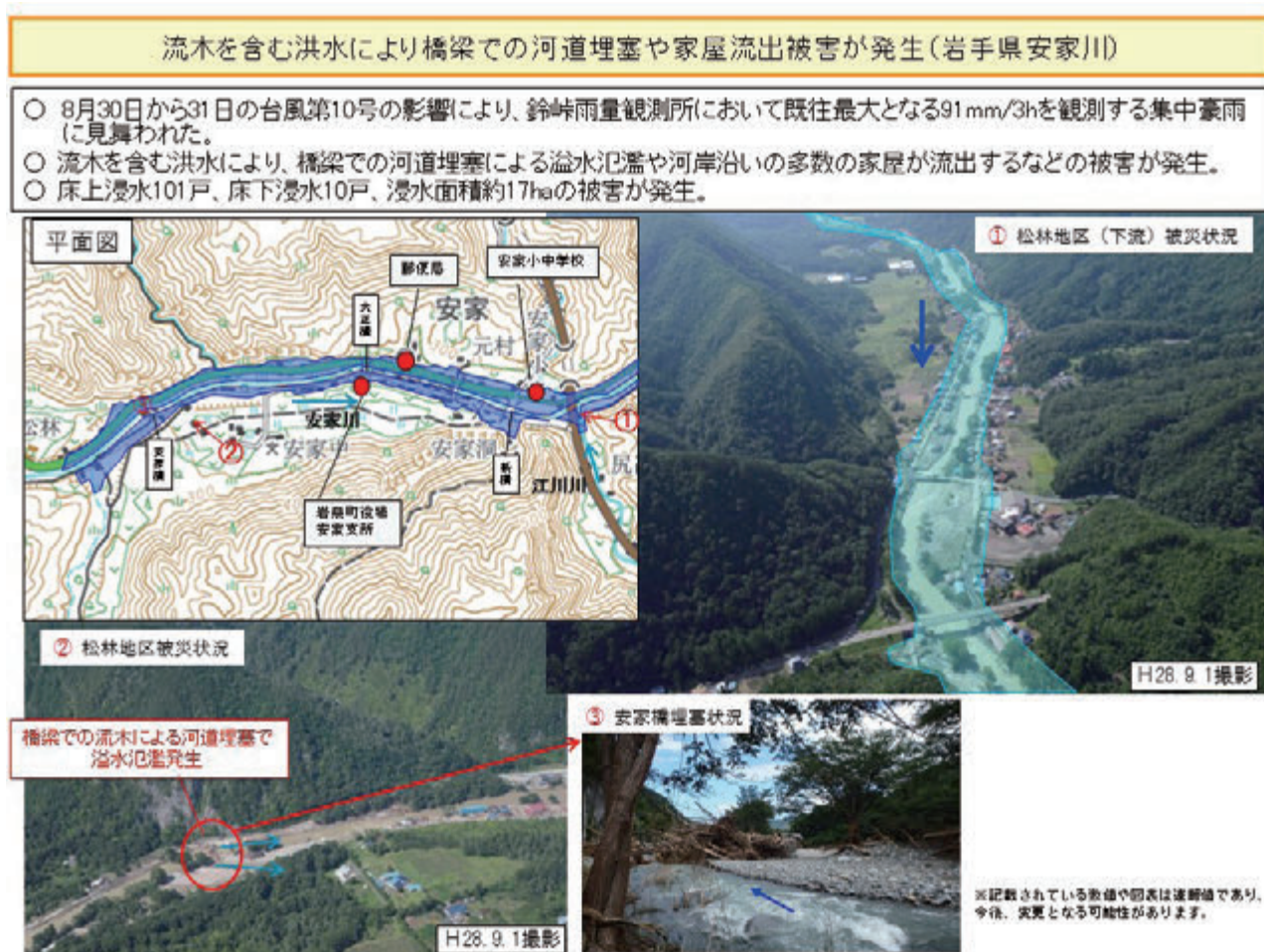
【図 2-12-12 流木を含む洪水により橋梁での河道埋塞や家屋流出被害が発生(岩手県安家川)】
