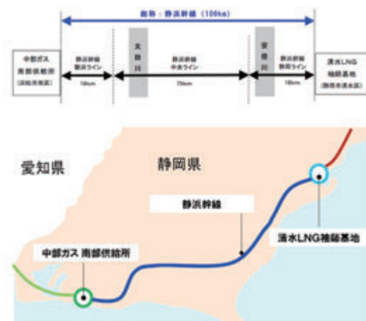
【静岡－浜松間を結ぶパイプライン「静浜幹線」概要図】
