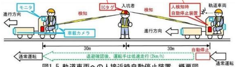
図1.5 軌道車両への人接近時自動停止装置 概要図
