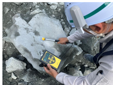
コンクリートテスター測定
