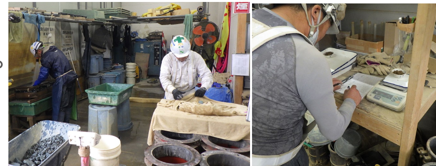
CSG材品質管理試験の状況
