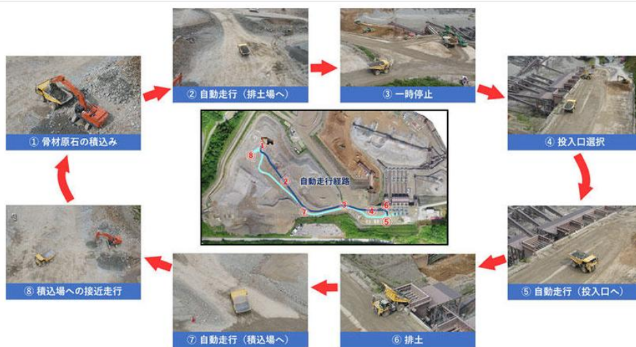
写真2 骨材原石の運搬作業手順
