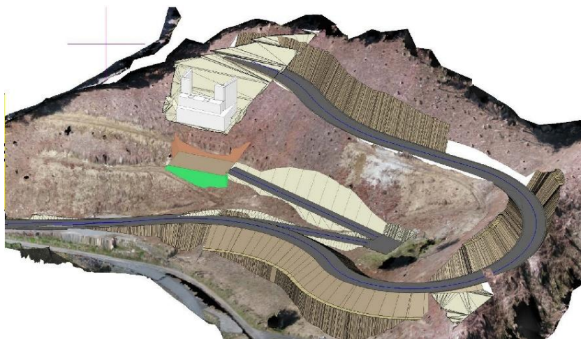
3次元で作成した工事用道路計画図
