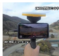
ハンディ型モニターを用いた現場でのCIMモデル確認
