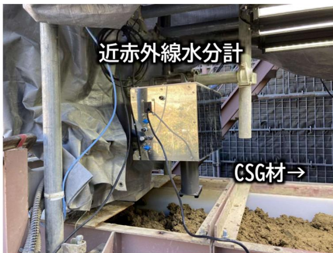
近赤外線水分計による表面水量測定
